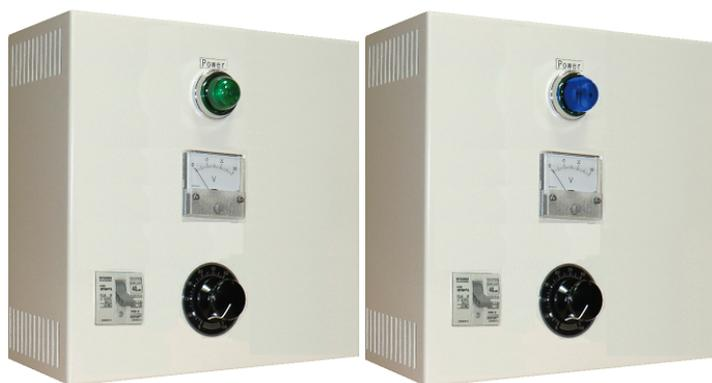
ロータリーエンコーダーを使用して、ベルトコンベアやラインの速度に比例した加熱温度制御を行います。ラインスピードが速くなるとヒーター出力を上げ、ラインスピードが遅くなればヒーター出力を下げます。光電スイッチと同期して、ワークの有るときだけ加熱を行います。微調節は、表面搭載のダイヤルで行います。
