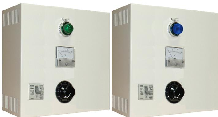
ロータリーエンコーダーを使用して、ベルトコンベアやラインの速度に比例した加熱温度制御を行います。ラインスピードが速くなるとヒーター出力を上げ、ラインスピードが遅くなればヒーター出力を下げます。ラインが停止すると、ヒーターも停止します。微調節は、表面搭載のダイヤルで行います。
